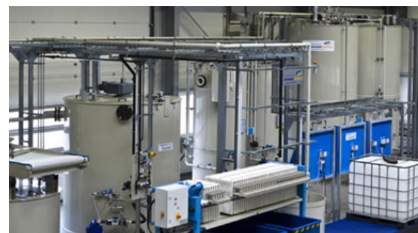
Рисунок 19 — Очистка воды химическим методом
